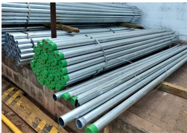
Foto 02 – postes em aço galvanizado com 3,60m de comprimento
