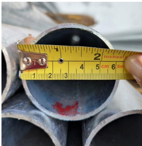
Foto 01 – diâmetro do posto em aço galvanizado
