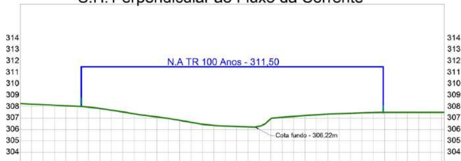
Figura 22: Capacidade hidráulica perpendicular ao fluxo da corrente
