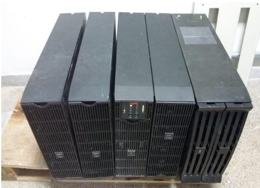
Figura 2 – Nobreak secundário com seu banco de baterias.
