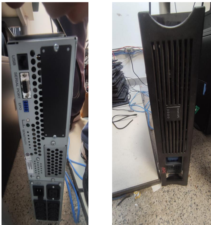
Figura 3 – Nobreak de 3KV's com banco interno de Baterias.
