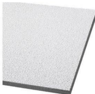
Placa de fibra mineral para forro, 625 x 625 mm, e = 15 mm, borda reta, com pintura antimofo.
