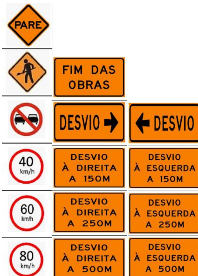
Figura 3-1 –Placas de sinalização em obra
