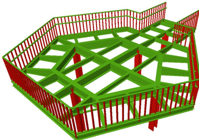
Figura 05: Estrutura 3D da plataforma elevada.
