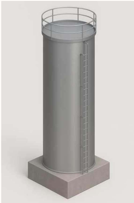
Figura 34. Reservatório cilíndrico RCi1 – Restaurante Universitário 10 m 3
