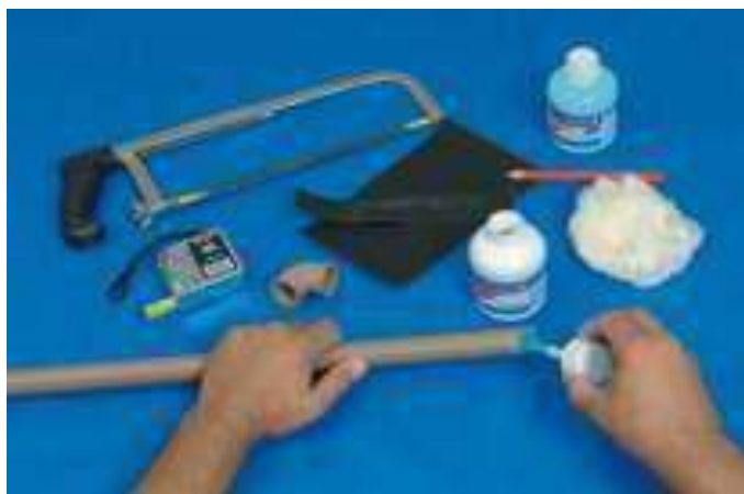
Figura 38. Execução da tubulação soldável - 3º passo.
