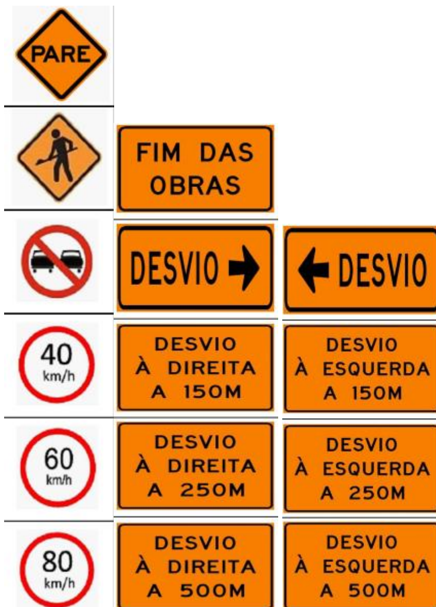
Figura 3-1 –Placas de sinalização em obra
