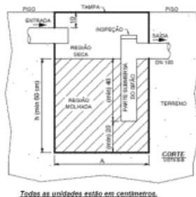
Figura 3 – Desenho ilustrativo da caixa de gordura
