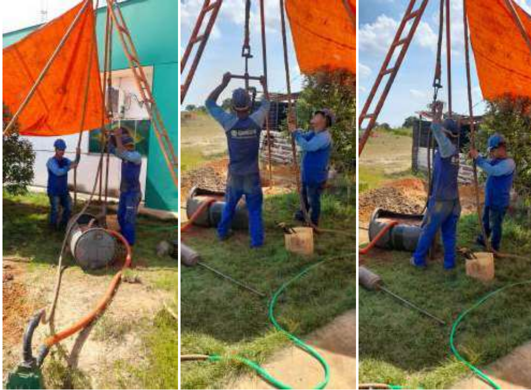
Quadro 1- Execução do furo de sondagem da base do Gefron no “trevo do limão”.
