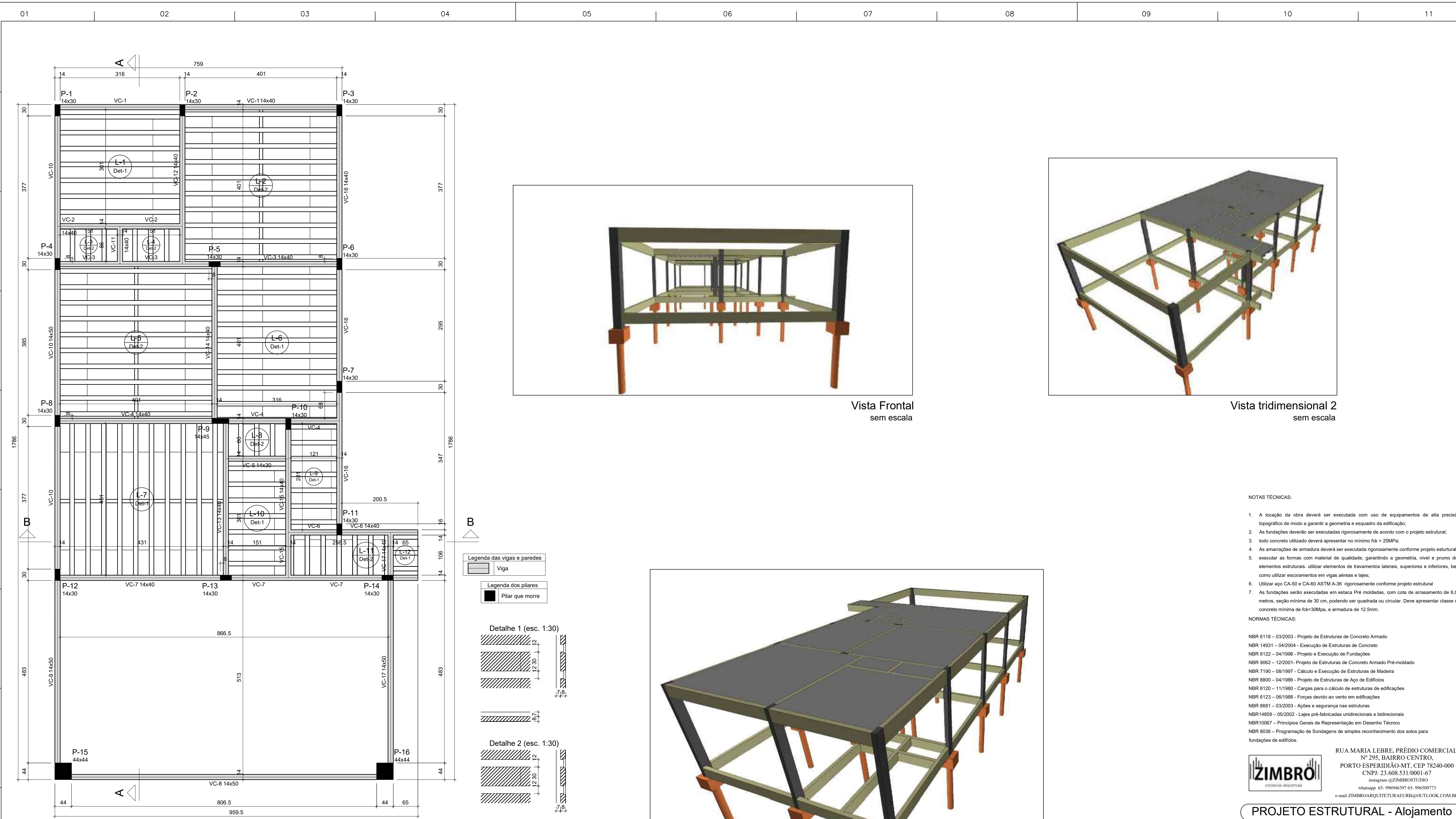
Forma do pavimento Pavimento (Nível 320) escala 1:50
