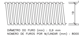
DETALHES DE TUBO DRENO CORRUGADO PEAD
