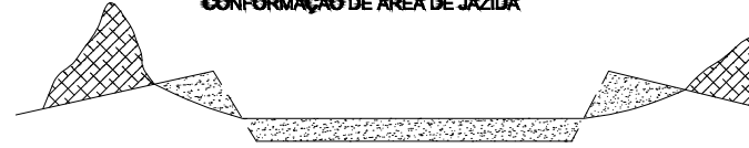
5 - CONFORMAÇÃO DE ÁREA DE EMPRÉSTIMO COM COBERTURA DE MATERIAL ORGÂNICO
