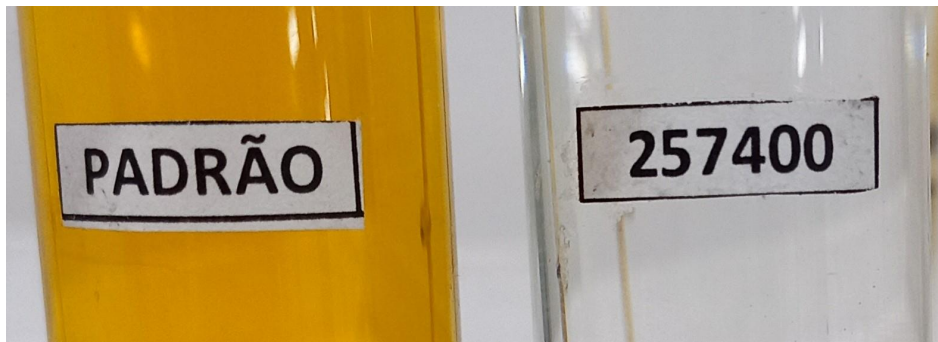
Foto 1 Ensaio comparativo de impurezas orgânicas. A amostra de agregado miúdo apresentou solução mais clara que a solução padrão, indicando ausência de impurezas orgânicas na areia.
