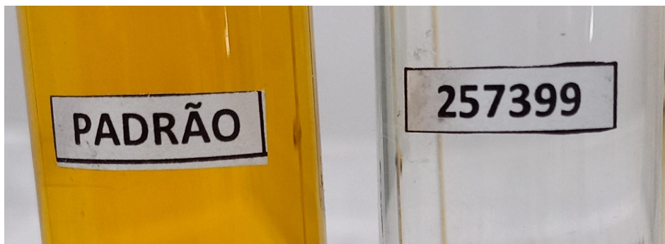
Foto 1 Ensaio comparativo de impurezas orgânicas. A amostra de agregado apresentou solução mais clara que a solução padrão, indicando ausência de impurezas orgânicas na amostra analisada.
