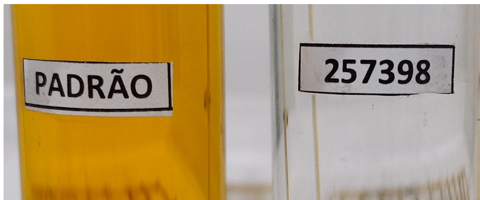
Foto 1 Ensaio comparativo de impurezas orgânicas. A amostra de agregado apresentou solução mais clara que a solução padrão, indicando ausência de impurezas orgânicas na amostra analisada.
