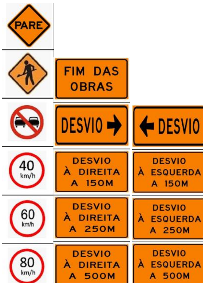
Figura 4-2 –Placas de sinalização em obra
