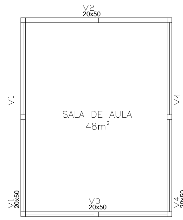
LOCAÇÃO DE VIGAS ESCALA 1:100
