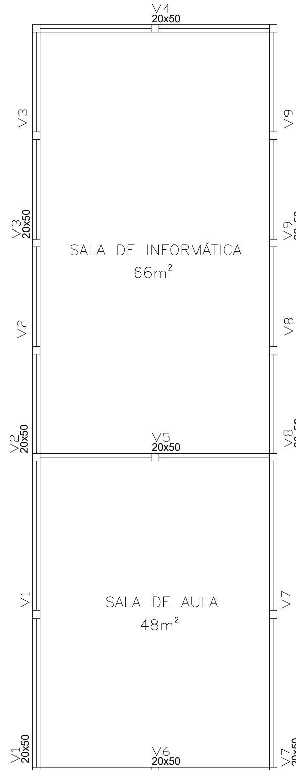
LOCAÇÃO DE VIGAS ESCALA 1:100
