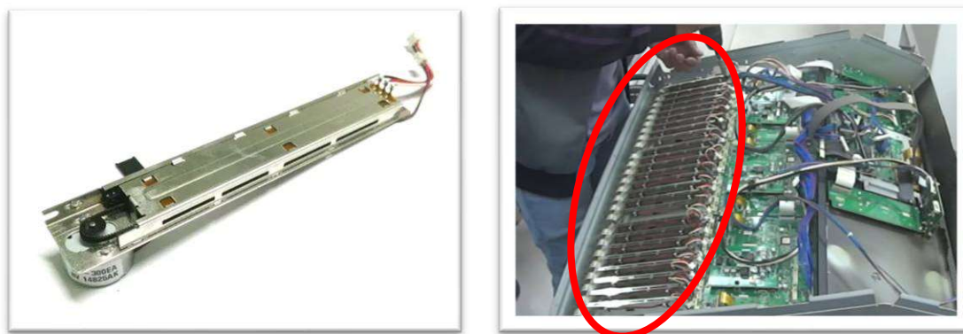
Fader motorizado (esq.) e Mixer TF em manutenção (dir) – faders em destaque
