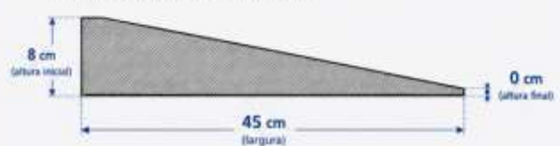
CORTE TRANSVERSAL (no meio da rampa)
