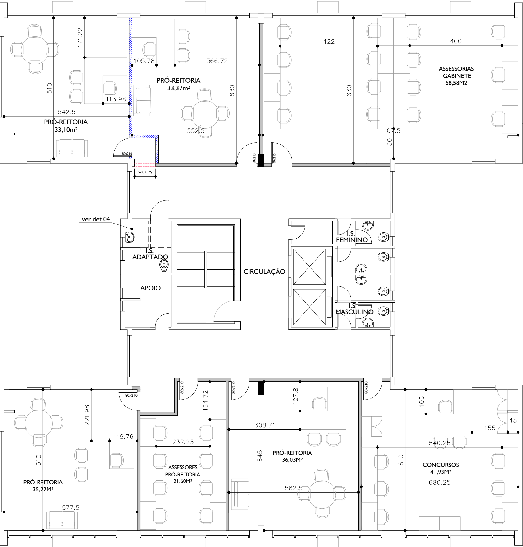
EDIFÍCIO ANTÔNIO CARLOS: PLANTA - 8º PAVIMENTO Escala 1:100
