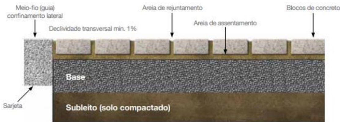
Figura 2: Estrutura típica dos pavimentos intertravados.
