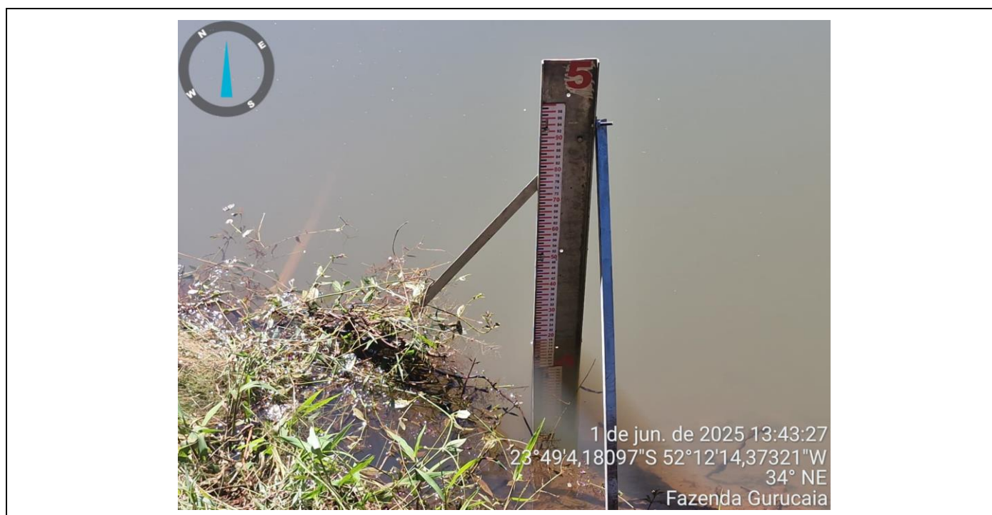
Figura 3-5: Perfil metálico dobradas em formato em U, com cantoneiras instaladas em área com lâmina d'água. A régua linimétrica representada nesta imagem é meramente ilustrativa, não devendo ser utilizada como referência em suas especificações.
