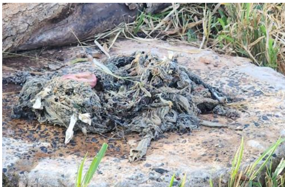
Figura 12: Resíduos que aderiram na mangueira do hidrojato durante o serviço com utilização do produto químico executado dia 08/07/2025
