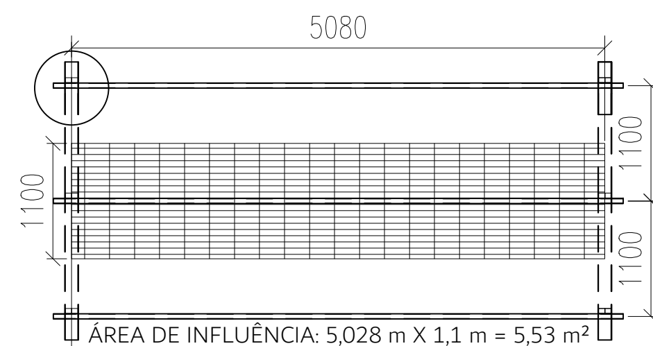
ÁREA DE INFLUÊNCIA MÁXIMA DAS TERÇAS ESCALA 1:50
