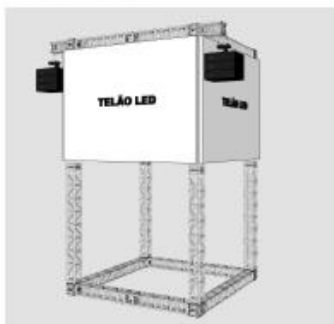
PERSPECTIVA 01 | TORRE DE DELAY 02 SEM ESCALA
