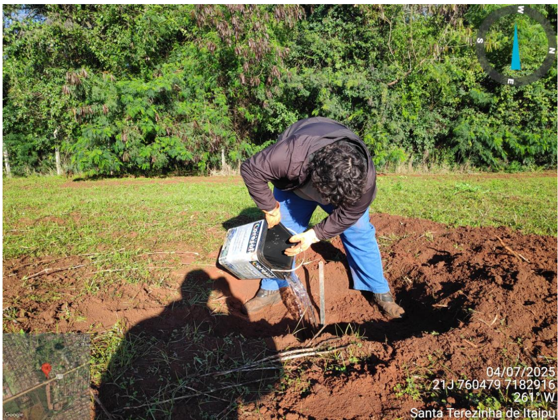
FOTO 06 – Teste de Percolação TP 02. (Fonte: Autoria própria, registrada em 04/07/2025).
