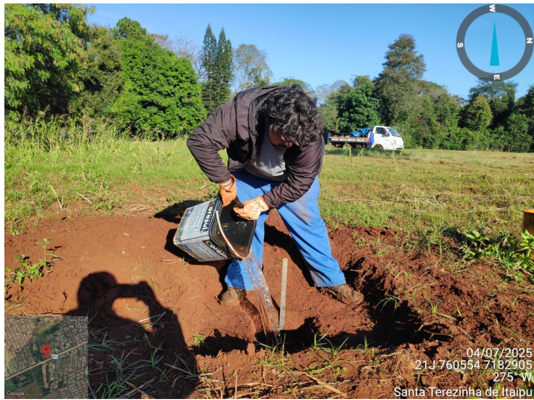
FOTO 10 – Teste de Percolação TP 06. (Fonte: Autoria própria, registrada em 04/07/2025).
