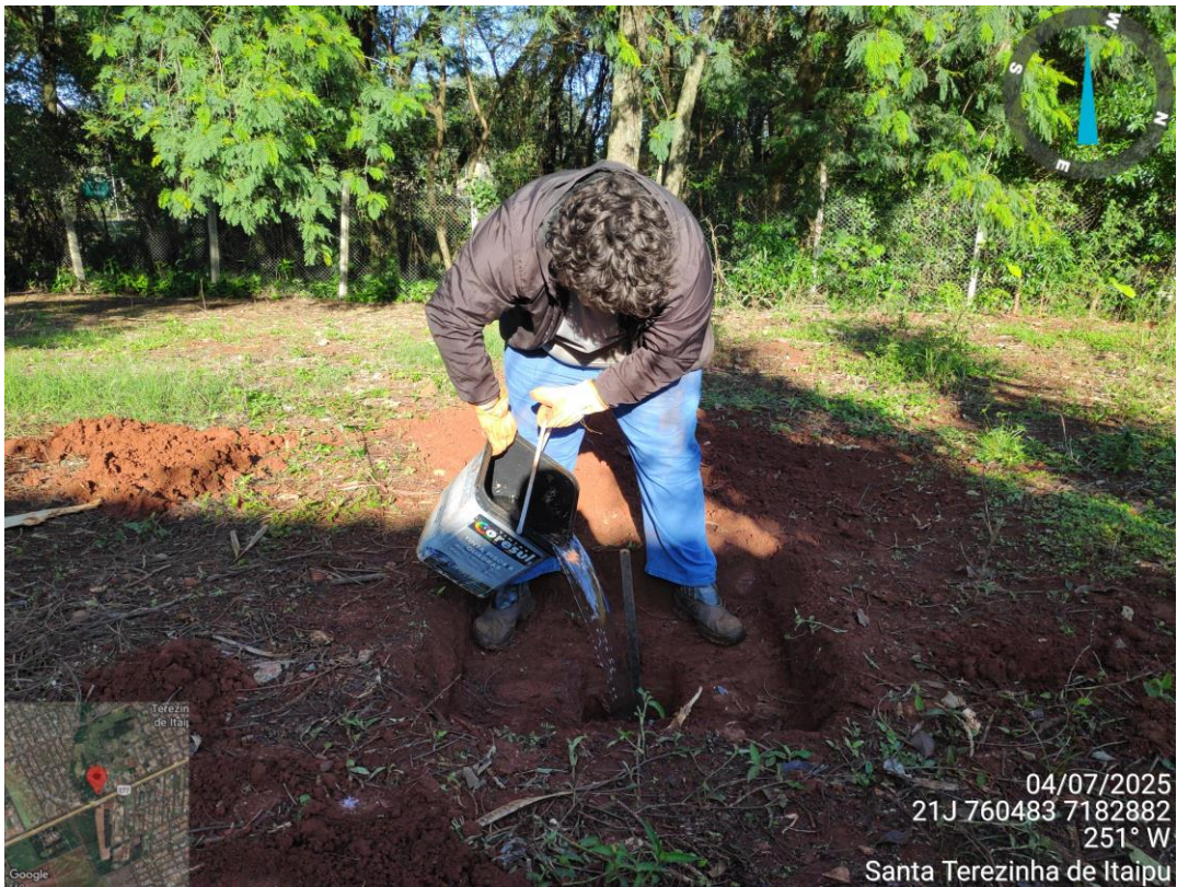
FOTO 05 – Teste de Percolação TP 01. (Fonte: Autoria própria, registrada em 04/07/2025).
