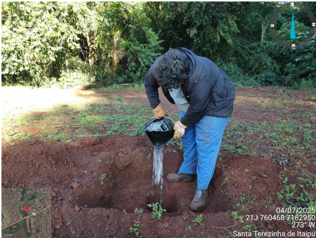
FOTO 07 – Teste de Percolação TP 03. (Fonte: Autoria própria, registrada em 04/07/2025).
