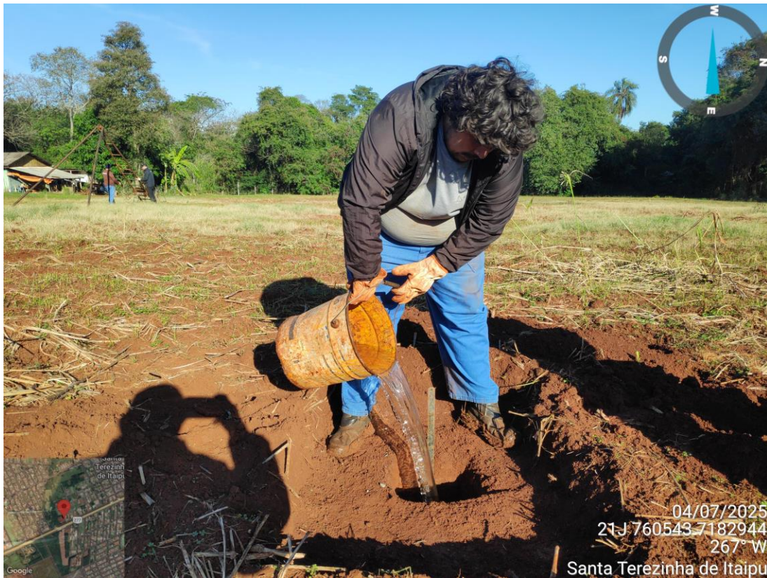
FOTO 09 – Teste de Percolação TP 05. (Fonte: Autoria própria, registrada em 04/07/2025).
