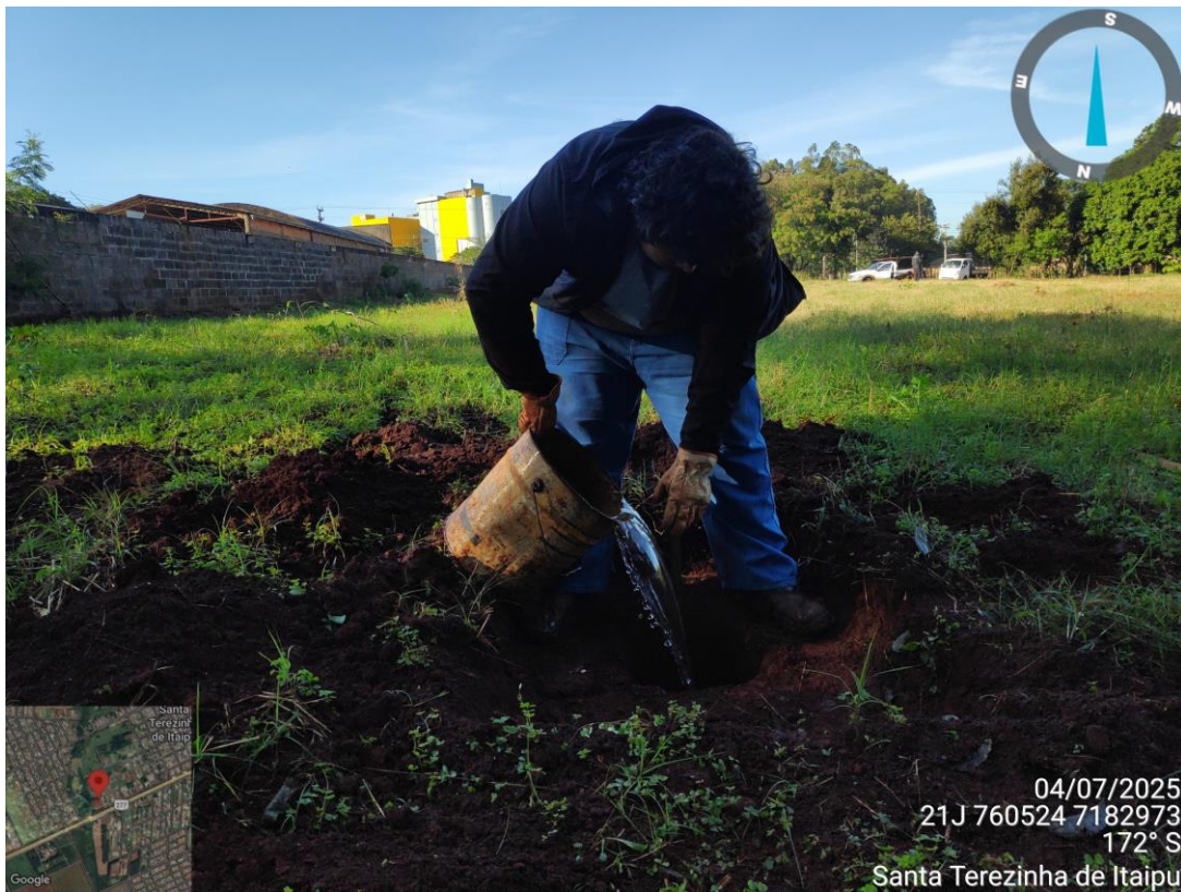
FOTO 08 – Teste de Percolação TP 04. (Fonte: Autoria própria, registrada em 04/07/2025).
