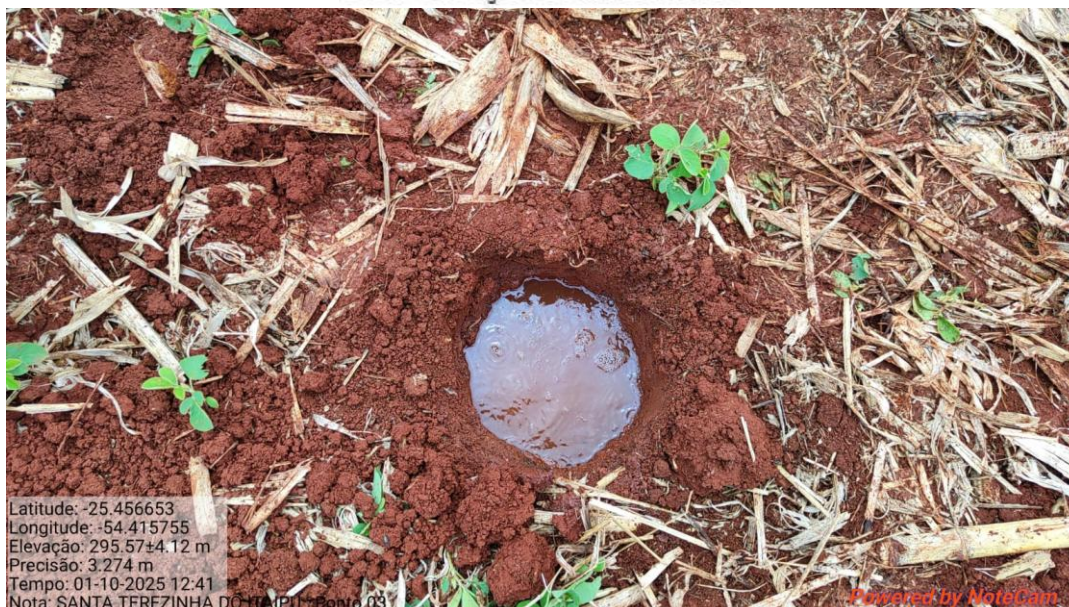
Fotos: ensaio de percolação. Fonte: Do autor, 2025.
