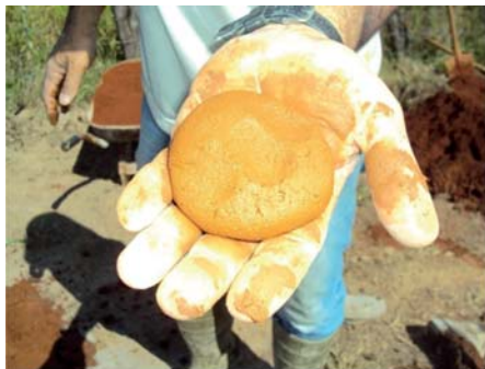
Figura 11 - Consistência adequada da massa
