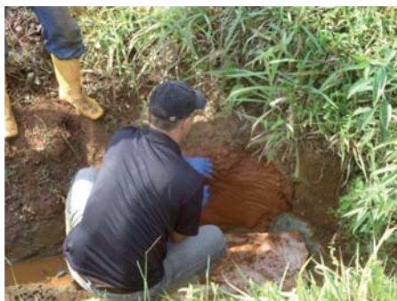
Figura 13 - Reboco das paredes do barranco
