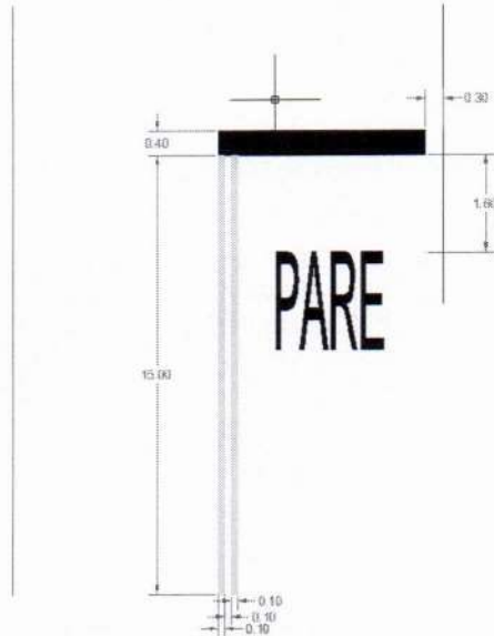
DETALHE SINALIZAÇÃO HORIZONTAL (PARE/FAIXA)
