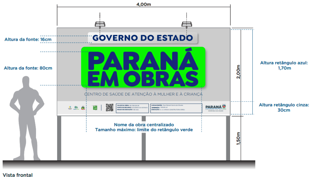
Figura 4 – Placa de obra padrão do Governo do Estado
