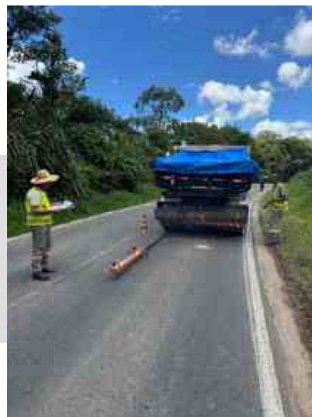
Figura 9 – Relatório fotográfico da execução do teste de carga com Viga Benkelmann
