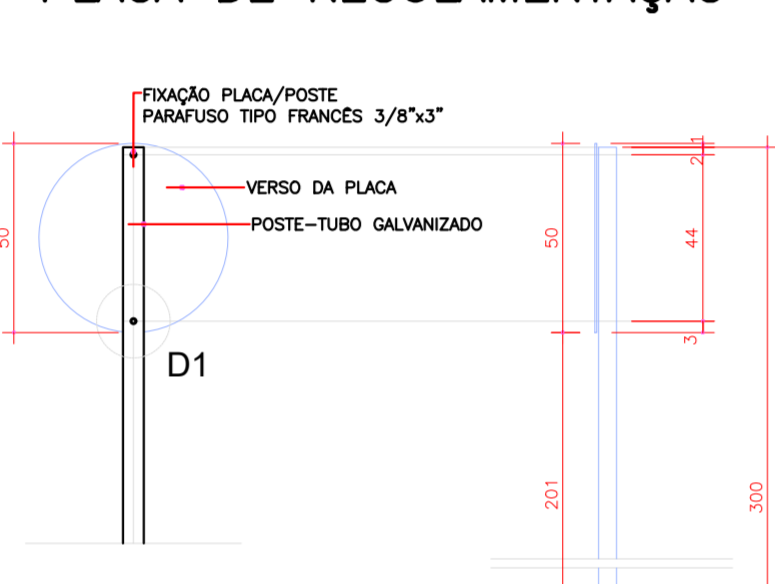
DETALHE FIXAÇÃO D1 ESCALA 1:20
