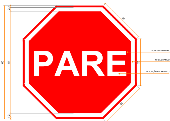
DETALHE R1 | PLACA DE SINALIZAÇÃO VERTICAL ESCALA 1/5
