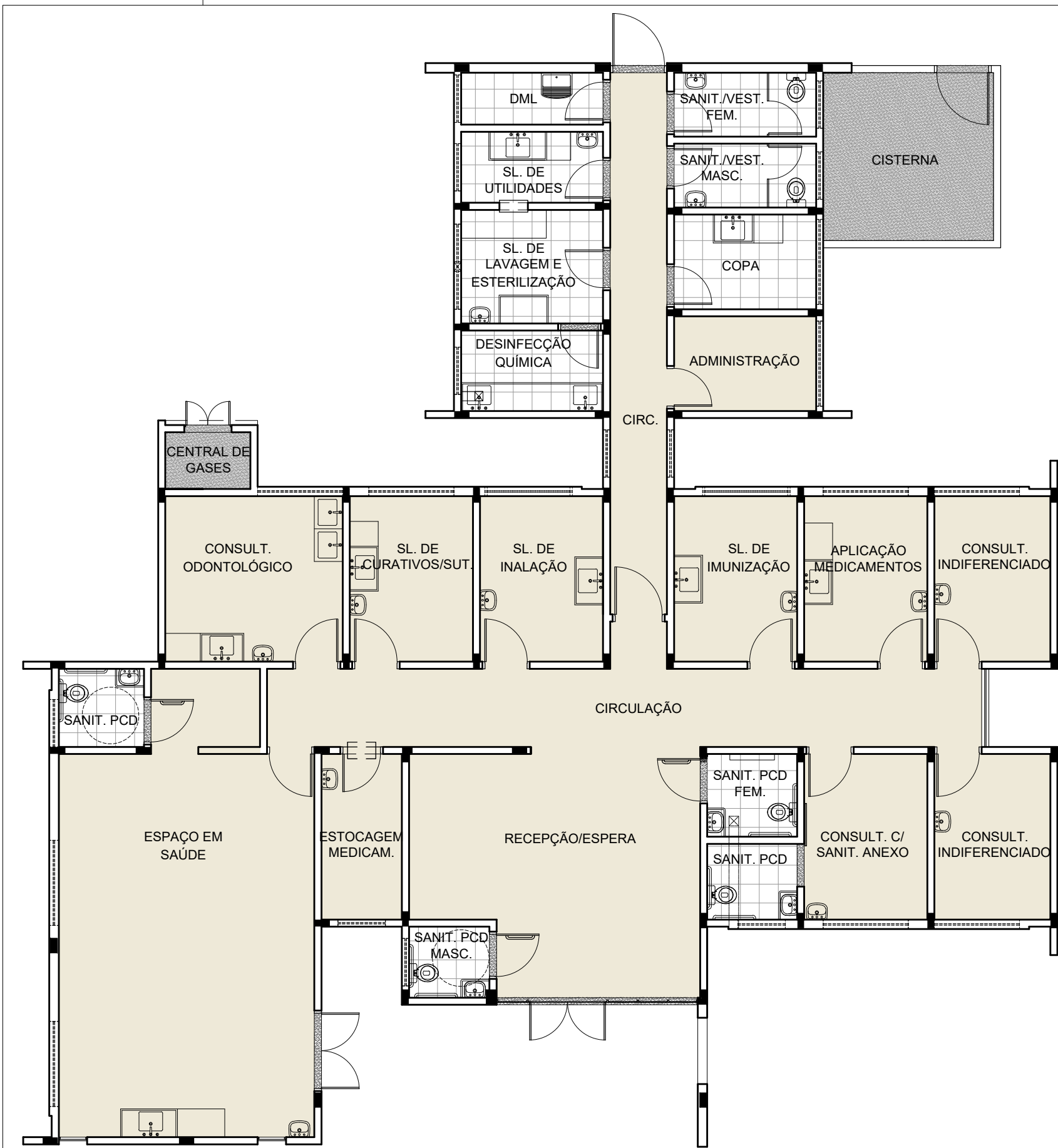
PLANTA ACABAMENTO-PISO ESCALA 1:100
