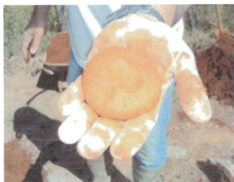
Figura 11 - Consistência adequada da massa
