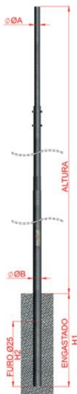
Imagem 06 – Poste aço galvanizado Fonte: Projeto elétrico, 2024
