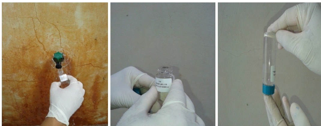
Figura 4 – Coleta em vial para VOC e THM: Formação da tensão superficial e ausência de bolha de ar no interior do vial.
