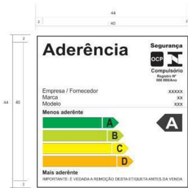
Figura 2 – Formato e dimensões do Selo de Identificação da Conformidade para utensílios com revestimentos antiaderente.
