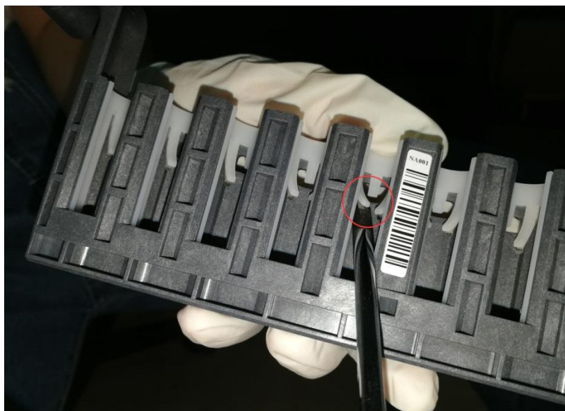
Fig. 4.6-1 Levantando o retentor
