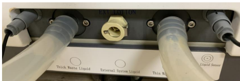
Fig. 3.4-3 Método de conexão para saída de resíduos
