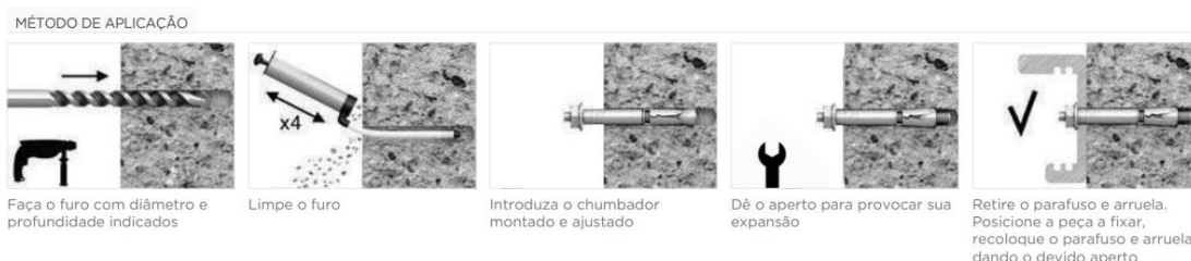
Figura 11 - Método de aplicação dos parafusos chumbadores
