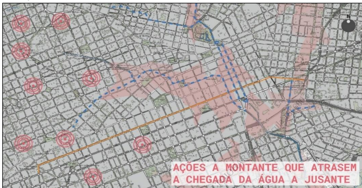
FIGURA 8: Rios canalizados e mancha de inundação (TR 25)
