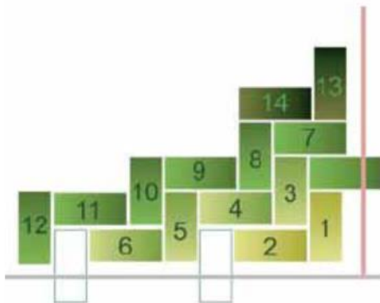
Corte dos blocos para acabamento e ajustes necessários
