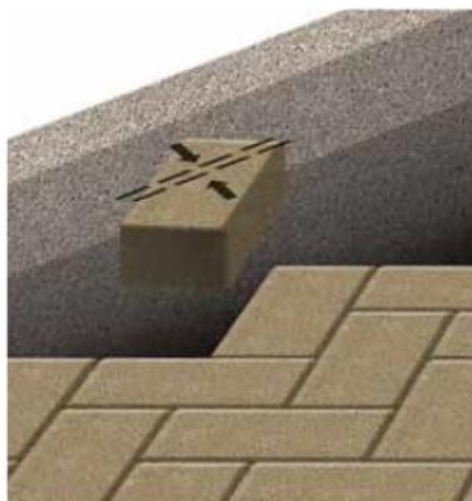
Marcação do bloco para corte
