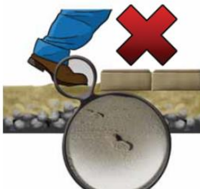
Deve-se consertar o solo antes do lançamento das peças de concreto.
