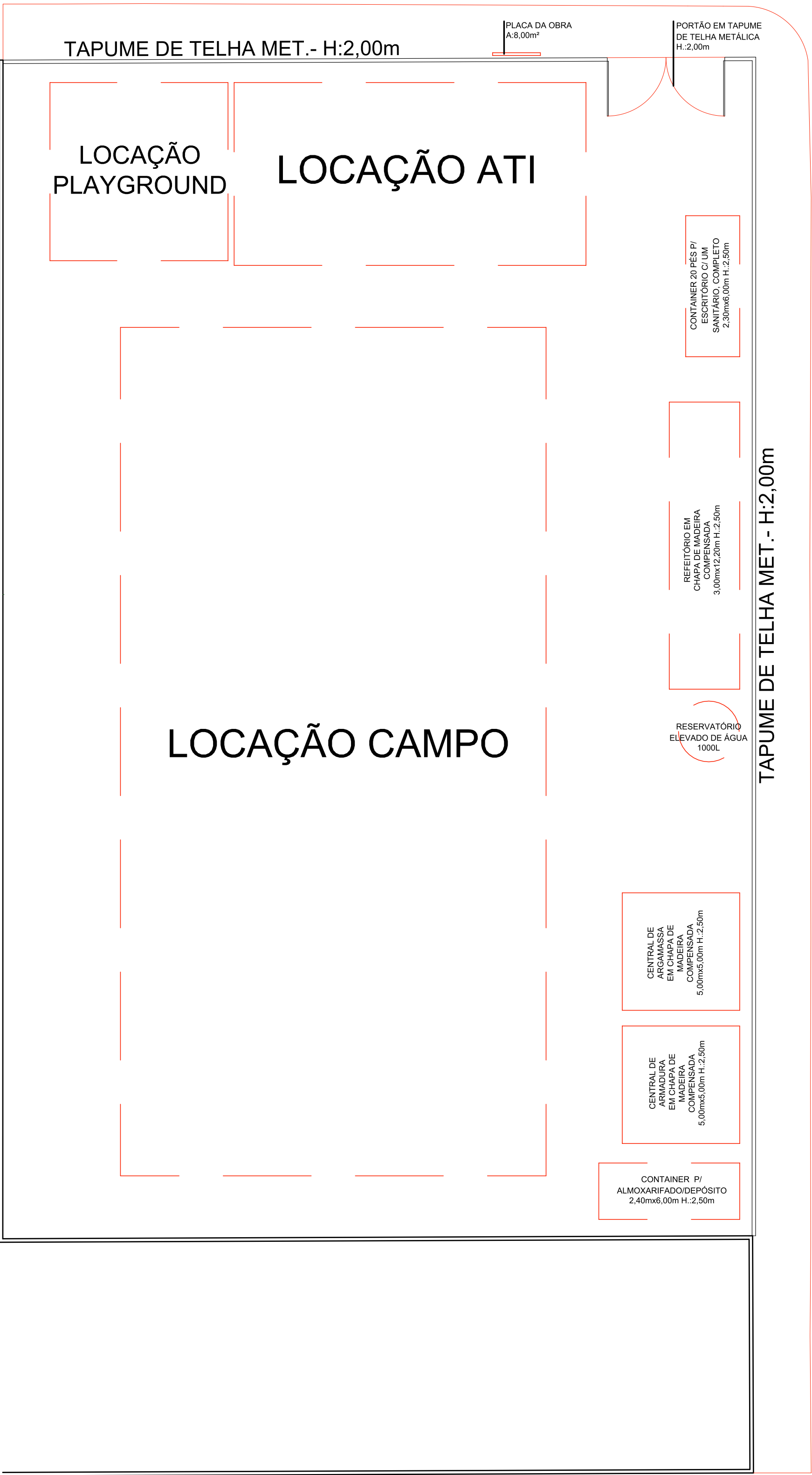
1 PLANTA - CANTEIRO DE OBRAS ESCALA 1:150
