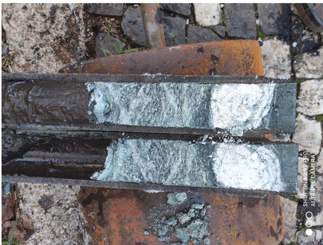
Foto 18 – Amostrador aberto expondo a recuperação dos residuais do Embasamento Cristalino, transpassados na sondagem SP-08. Foto do autor.
