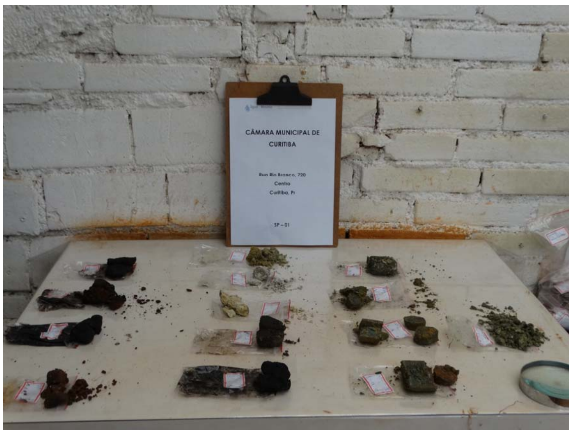
Foto 22 – Amostras da sondagem SP-01, obtidas a cada metro perfurado, preparadas para descrição. Início do furo, canto inferior esquerdo; final do furo, centro alto. Foto do autor.
