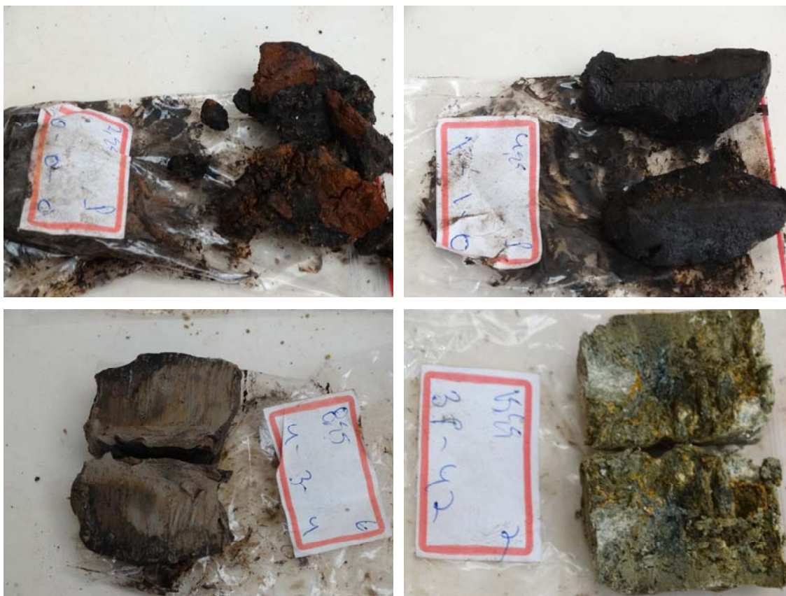
Fotos 23 a 26 – Amostras recuperadas das sondagens, do alto à esquerda: a) aterro não compactado; b) solo orgânico, negro, argiloso e mole; c) sedimento aluvionar, ocre, argiloso, mole e d) solo residual do Embasamento Cristalino, cinza esverdeado, silto argilo arenoso, compacto. Fotos do autor.
