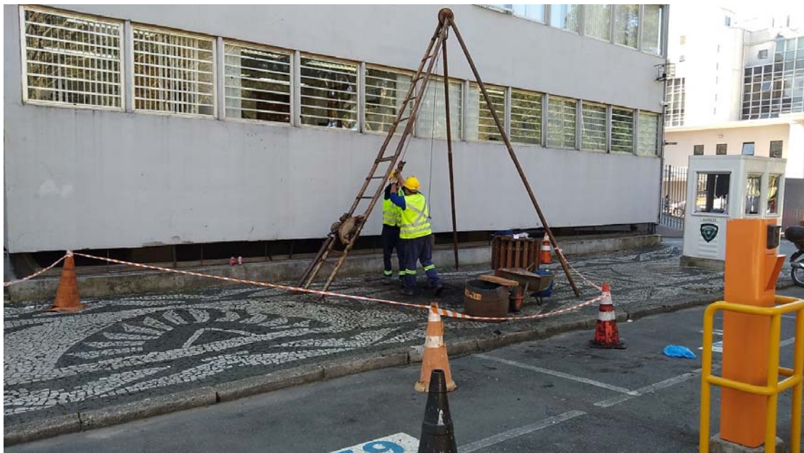
Foto 13 – Perfuração da sondagem SP-07. Foto Alexandre.
