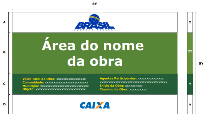
Figura 03: Padrão placa de obra
