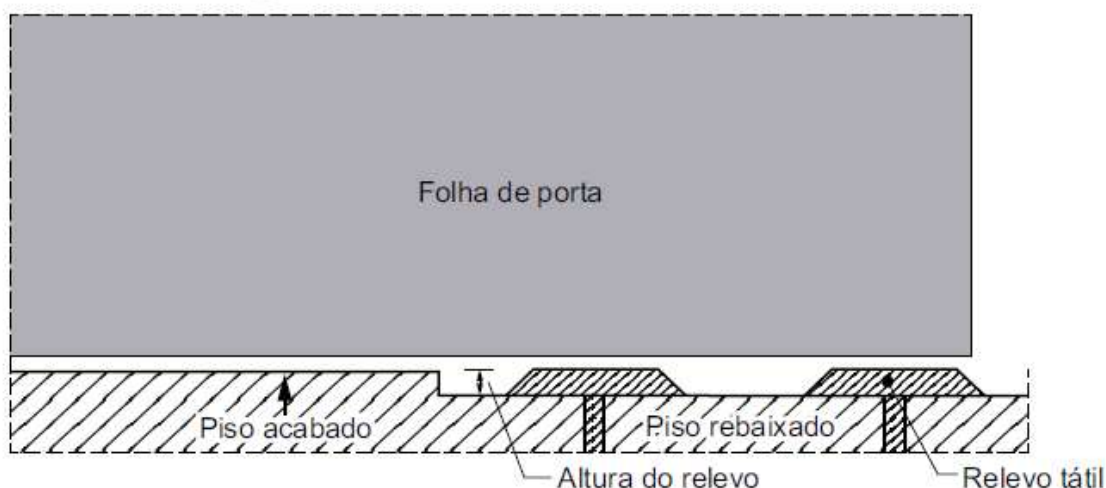
Figura 06: bloco intertravado de concreto tipo paver de alerta nivelado com o piso acabado.
