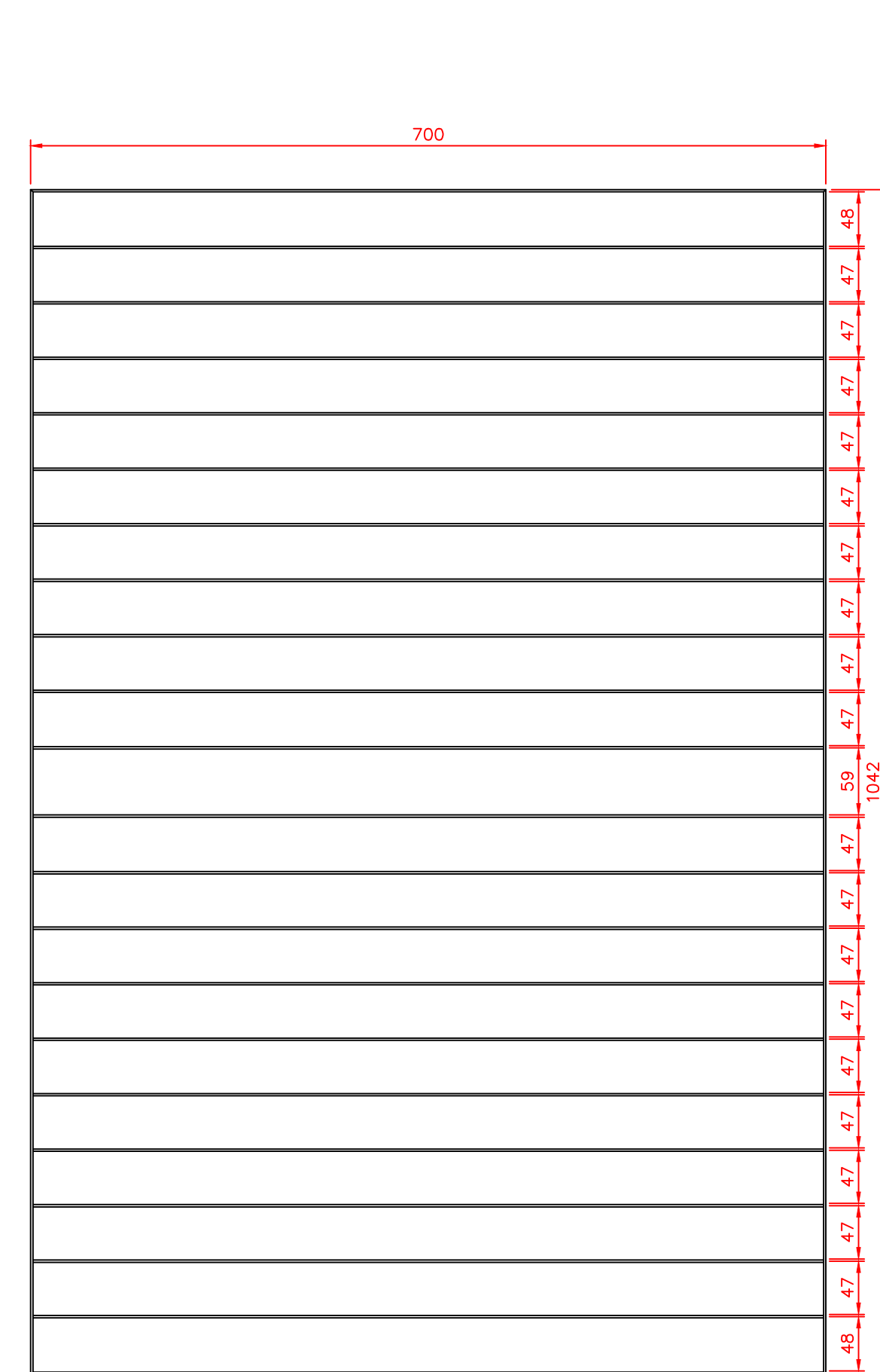
SISTEMA DE AQUECIMENTO SOLAR Esc. 1:50 | Dimensões do Suporte dos Coletores
