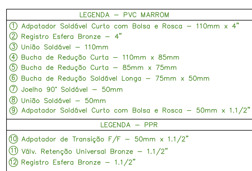
SISTEMA DE AQUECIMENTO SOLAR S/ Escala | Esquema de montagem - Bomba Hid. do Circuito Secundário
