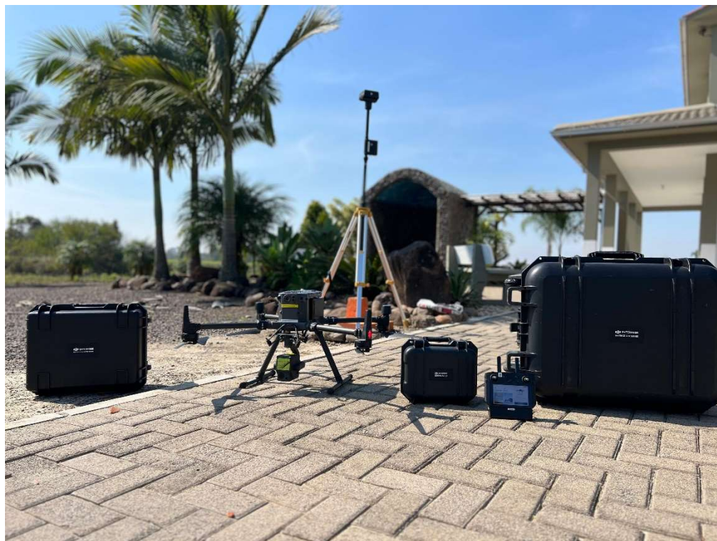
Drone RPAS MATRICE 300 RTK com Sensor ZENMUSE L1 – LIDAR. Fonte: Idealize, 2023.
