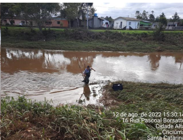
Figura 16: Coletas das amostras dos materiais sedimentados e acumulados junto ao Rio Sangão.
