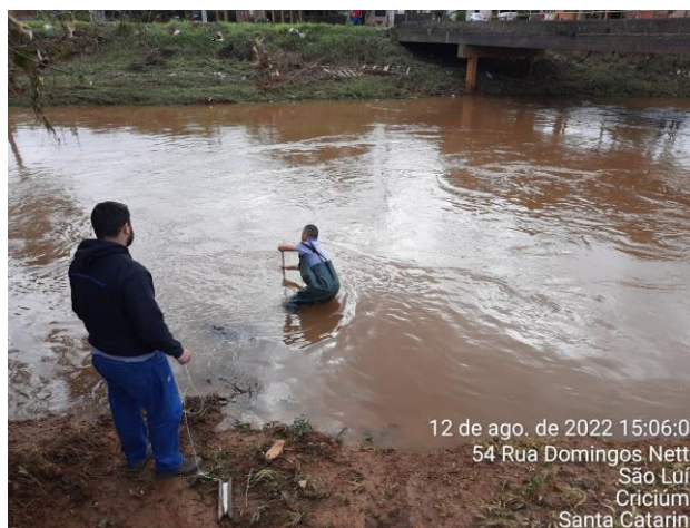
Figura 12: Coletas das amostras dos materiais sedimentados e acumulados junto ao Rio Sangão.
