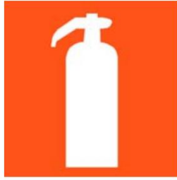
Figura 1 - pictograma indicativo de extintor de incêndio
