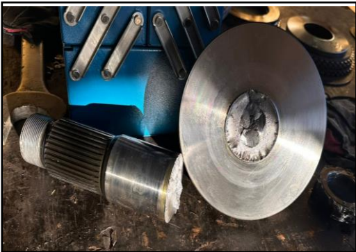
Peças danificadas Comando do Gira círculo Motoniveladora CAT 120K
