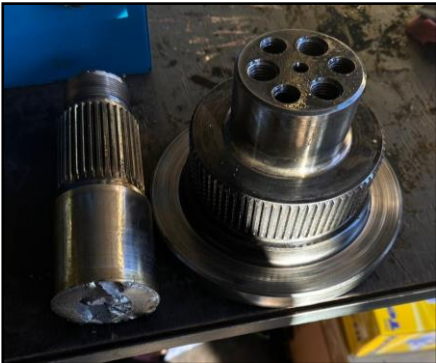
Peças danificadas Comando do Gira círculo Motoniveladora CAT 120K
